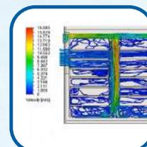
Cellule dotée d'un convoyeur d'air frais assurant une uniformité de la température dans tous les compartiments
