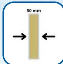
Isolation de la cellule en mousse polyuréthane expansé de 50 mm d'épaisseur
