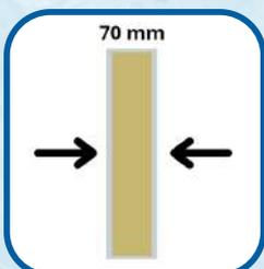
Isolation de la cellule en mousse polyuréthane expansé de 70 mm d'épaisseur
